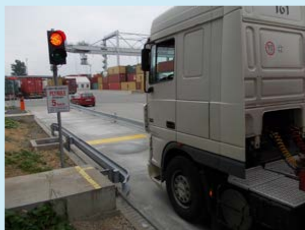
Sistem WIM cu viteză redusă în METRANS Česká Třebová
