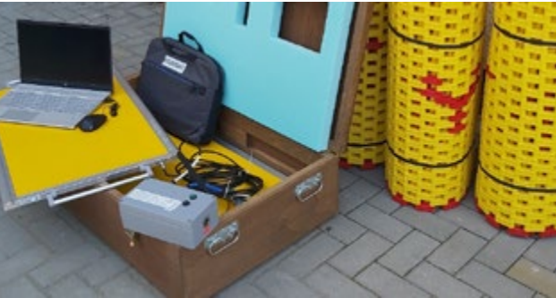
Sestava přenosných vah PW-10. Sada obsahuje 2 kusy vážících plošin a 4 kusy vyrovnávacích podložek.
