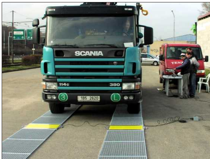
Merenje vozila tokom vožnje preko mernih površina.
