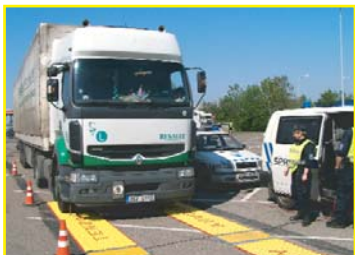
obr. 1.: Vážení na mobilních vahách – pomalé a pracné
