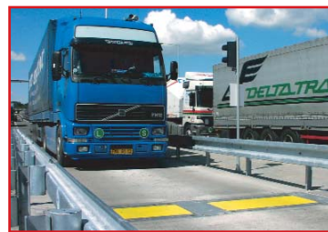
obr. 2.: Úřední vážení za jízdy při rychlosti do 16 km/h na váze typu VM-2.2
