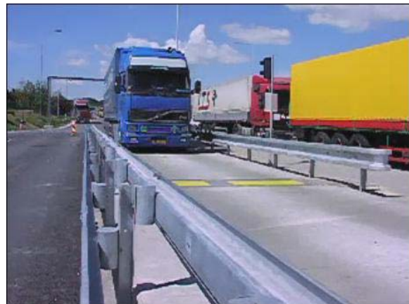
obr. 3 a 4: Instalace váhy VM-2.2 do vážní zóny a provoz přes váhu rychlostí až 16km/h
