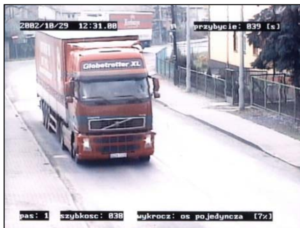
obr. 10 a, b: V Polsku vybudovaná HSWIM stanice pro předvýběr vozidel z dopravního proudu k převážení na pevně zabudovaných vahách
